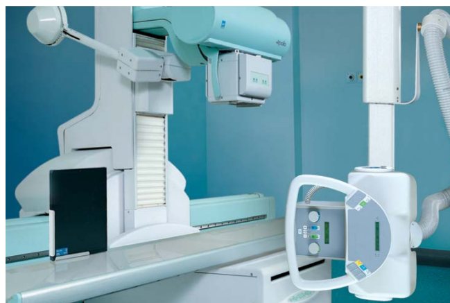
Accoppiato a tavoli con comando remoto, LEM Plus può eseguire proiezioni laterali.
