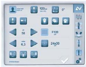
Nelle versioni di alta gamma, l'intuitiva interfaccia utente **touch screen** integrata sul tubo radiogeno permette di controllare facilmente e con pochi tocchi tutti i parametri principali del sistema. La possibilità di
