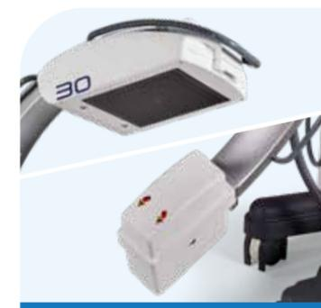
Centratura a zero dose con centratori laser lato tubo radiogeno e flat-panel.
